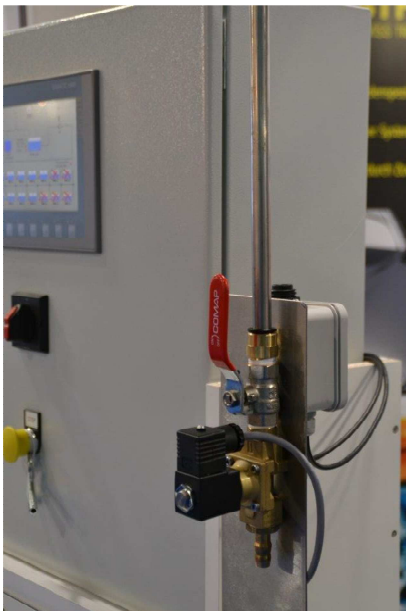
2: Computergesteuerte Ventile sorgen für die optimale KSS Versorgung der Werkzeugmaschine
